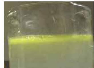
Die geringste Emulsionsneigung zeigte sich beim teuren Lein-Öl (16 €/L) unten.
